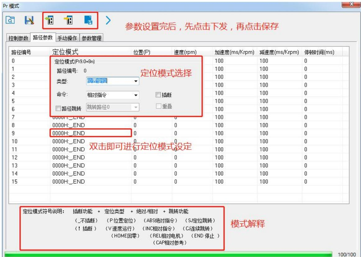
②路径位置、速度、加减速度和停顿时间设定：
