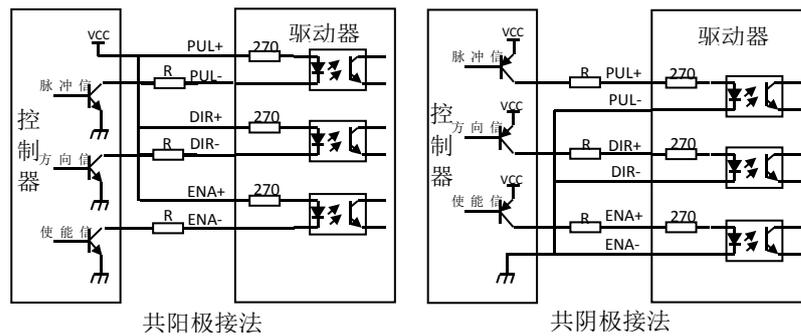
图 1 输入接口电路
