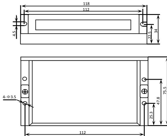
图 2 安装尺寸图(单位: mm)
