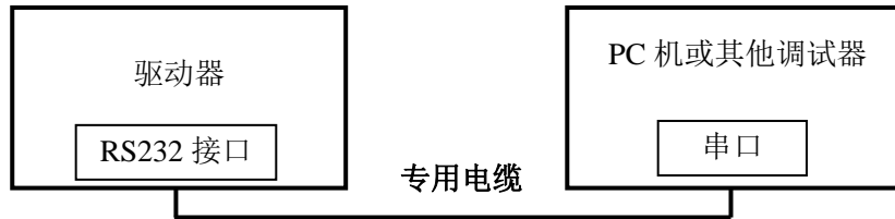
图 6 参数调试接线原理图
