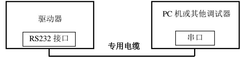
参数调试接线原理图
