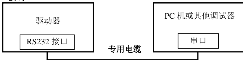
图 6 参数调试接线原理图
